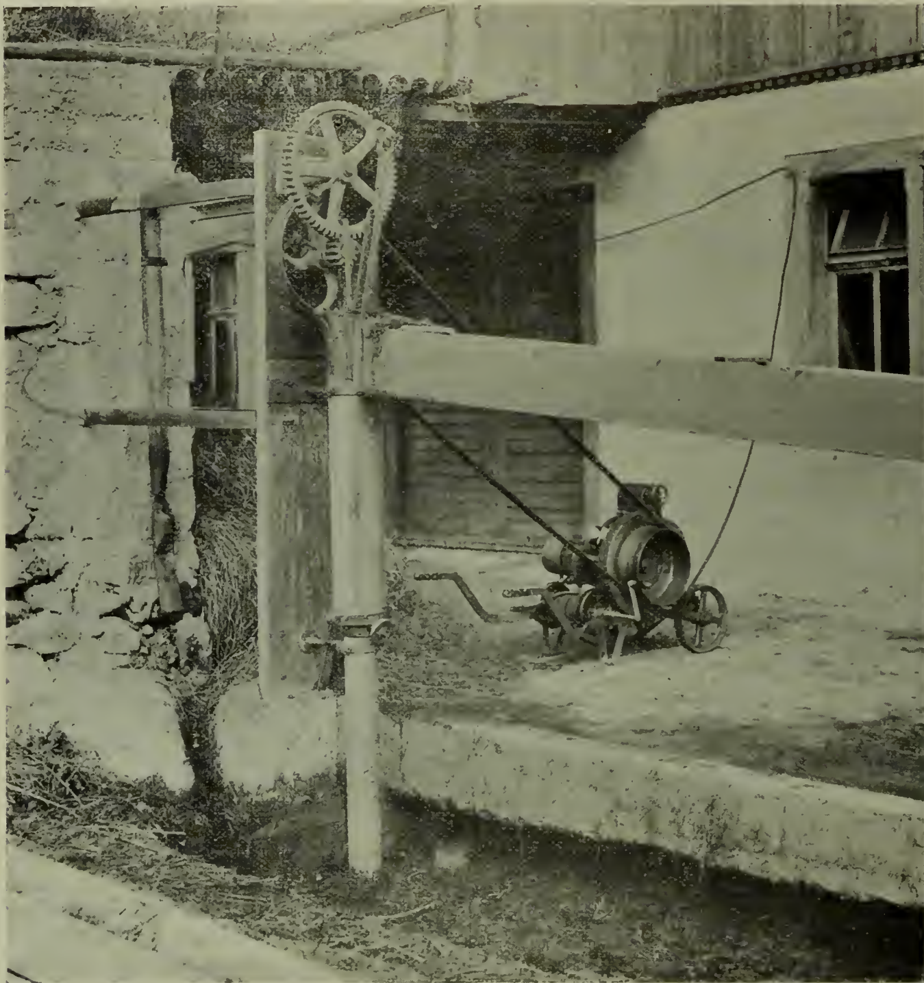
Fig. 176. — Commande d'une pompe à purin par un moteur électrique transportable.
